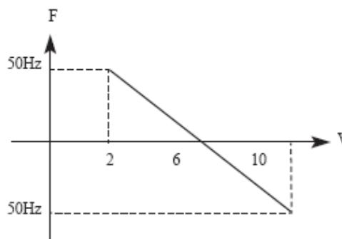
Príklad 2, výstup z riadiaceho PC je 4 – 20 mA a menič má nastavený parameter Výstupná frekvencia: 100 Hz – 0 Hz
