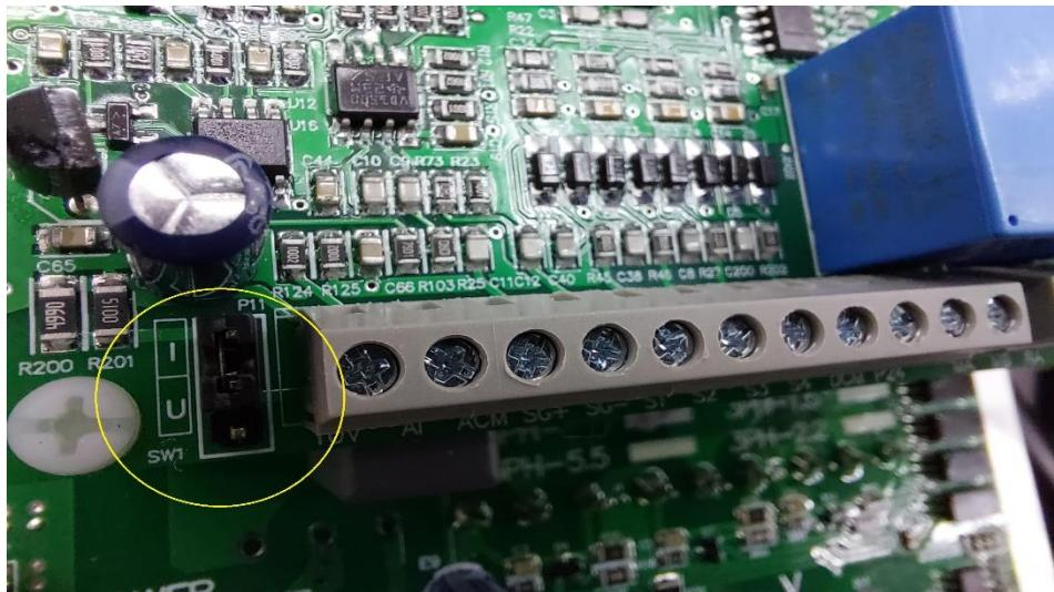
Príloha č.5 umiestnenie SW1 ma modeloch nad 7.5 kW
