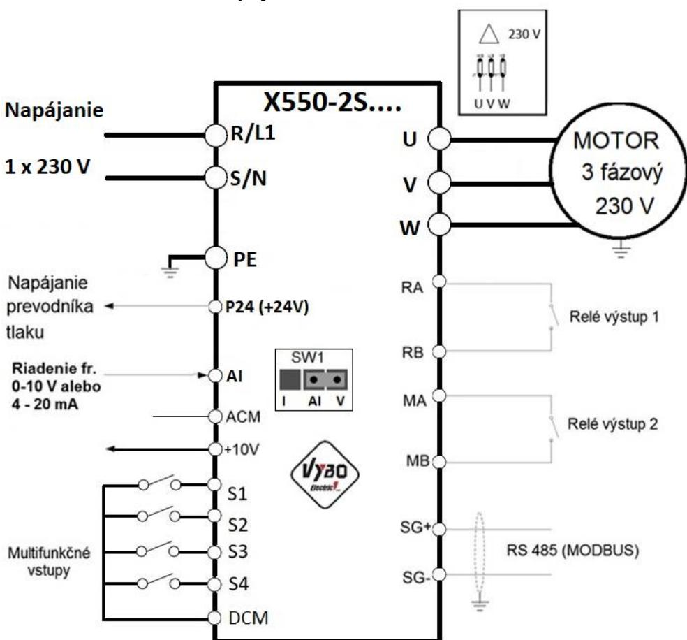
Rozloženie ovládacích svoriek (0.7 až 2.2 kW typov 2S):
