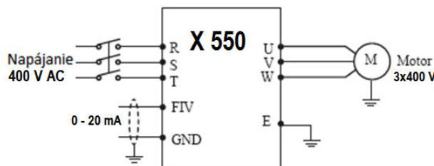
Vysvetlenie: riadiaca výstupná frekvencia meniča sa ovláda pomocou AI / FIV prúdového signálu 0 až 20 ma , alebo 4 až 20 mA.
