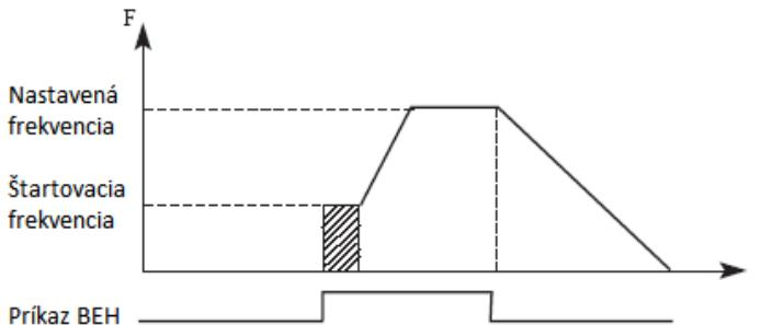
Štartovacia frekvencia je počiatočná frekvencia pri štarte meniča. Pri zariadení s veľkým zaťažením alebo vyžadujúcim veľký rozbehový krútiaci moment sa zvyšuje štartovacia frekvencia. Ak je však štartovacia frekvencia príliš vysoká, môže to spôsobiť aktivovanie nadmernej ochrany.
