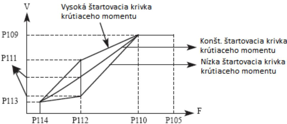
Krivka krútiaceho momentu s vysokým začiatkom: aplikácia pre vysoké zaťaženie a zaťaženie, ktoré si vyžaduje vysoký rozbehový moment.
