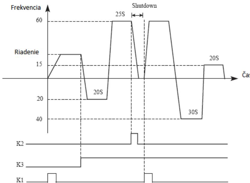
Pokyny: ① Pre spustenie meniča stlačte tlačidlo K1 a potenciometrom nastavte výstupnú frekvenciu.
