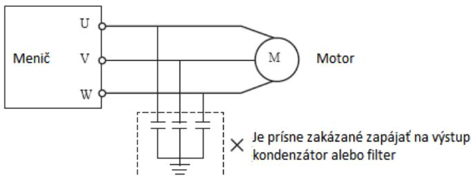
(11) Pred začatím zapájania alebo inej práce po vypnutí meniča, počkajte najmenej 10 minút po vypnutí napájacieho zdroja a testerom skontrolujte, či nie je prítomné zvyškové napätie. Kondenzátor je nabitý na vysoké napätie a určitú dobu po vypnutí je nebezpečný.
