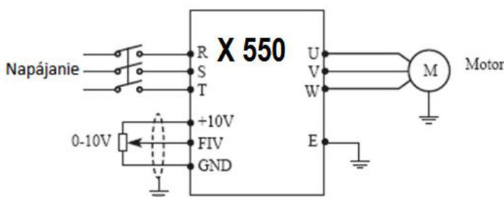
Vysvetlenie: riadiaca výstupná frekvencia meniča sa ovláda pomocou AI / FIV napäťového signálu z externého POT (10 kΩ).
