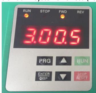
Zobrazenie "SLP" sa zmenilo na "3.0 0.5" displej meniča zobrazuje vľavo hodnotu požadovaného tlaku 3.0 bar a v pravo zobrazuje hodnotu tlaku v systéme, t.j. 0.5 bar.
